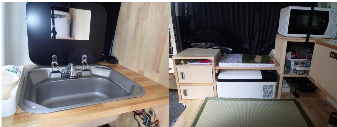
左：洗面器の蓋を上げたところ。鏡は、アルミ蒸着フィルムを張り付けたもの。右：運転席の後ろ側。運転席と荷室はカーテンで仕切る。左から、下駄箱、冷蔵庫、右側の棚の上に電子レンジ（走行中暴れないようにベルトで縛る）、中段は雑物入れ、下段は V/U 無線機（FTM100DH）の本体部分（コントローラは運転席コンソールにある）。
