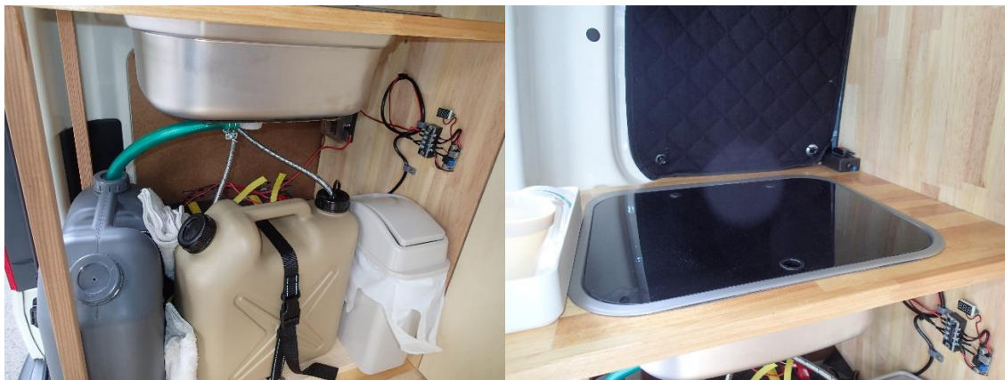
左：洗面台の下。清水タンク、排水タンクそれと水中ポンプの制御装置が見える。右：洗面台の上。蓋を上げて使用する。
